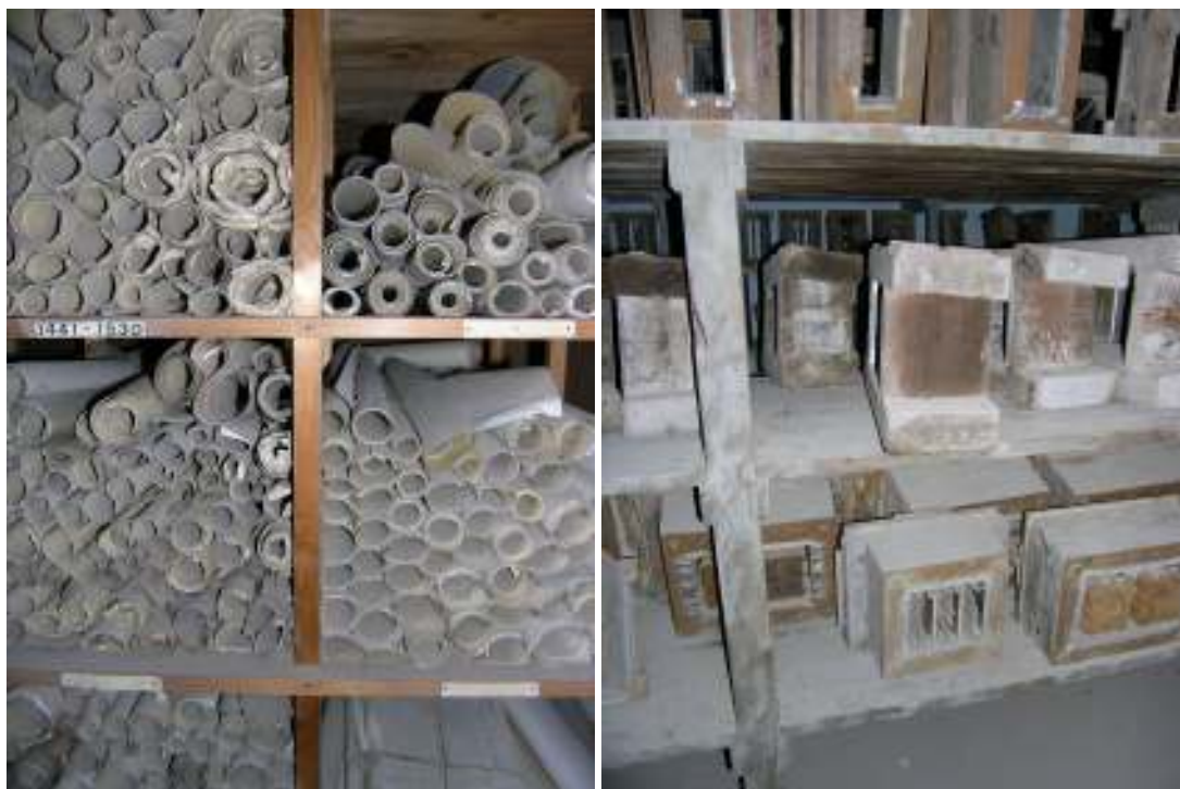
Rätningar till de allra äldsta produkterna på Skromberga. Munstycken där man tryckte ut lera till räfflade klinker.
