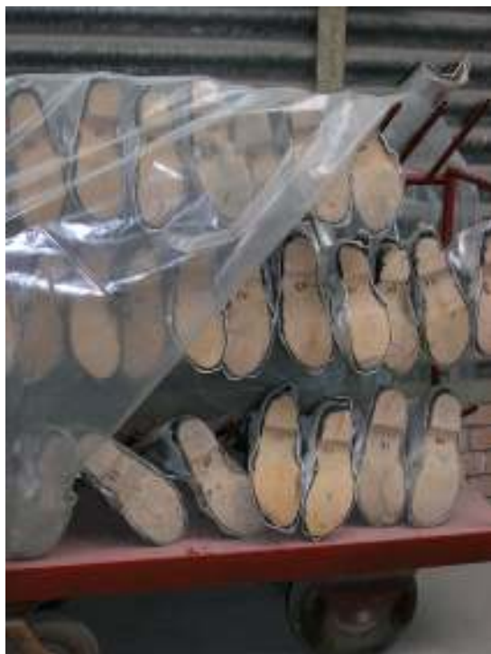
Skyddsträskor som klänts med värmeständig metallväv.
