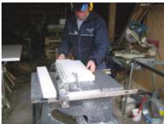
Tillkapning av cellplast.
